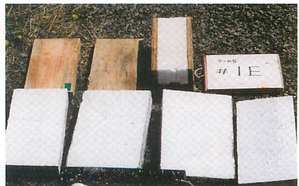
防蟻処理をしているAFM®社 パフォームガード®
