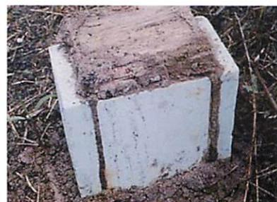
断熱材の隙間処理をしないと接合部を蟻道にしてシロアリが上に置いた木材を目指して上がってきます。(実験写真より)
